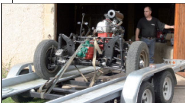
Un tout nouveau groupe motopropulseur, avec train AV et moteur assemblés, prêts à remplacer ceux qui sont montés sur Hachille.
