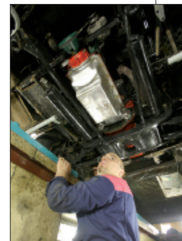
Réglage du parallélisme. Il nécessitera le remplacement des barres latérales.
